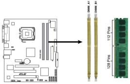
P5GZ-MX 240-pin DDR2 DIMM Sockets
