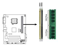
P5N-MX 240-pin DDR2 DIMM Sockets
