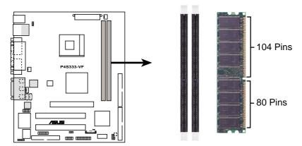
P4S333-VF 184-Pin DDR DIMM Sockets
