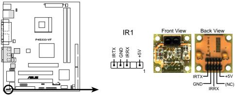
**P4S333-VF Infrared Module Connector**
