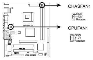
P4S333-VF 12-Volt Cooling Fan Power
